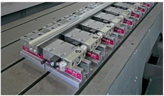
HILMA機械式バイスは、2つのデザインを採用しています。まず、油圧式 マシンバイスELは、機械、油圧式で、工具製造、金型製作、治具や備品の 製造、及び工業生産に使用されます。機械 - 油圧力は、クランクハンドル での小さな力で操作を行う事が出来ます。また、改良が可能な角ドライブ (オプション装備)は、例えば機械テーブル上に縦クランプを行う場合に使 用する事が出来ます。さらに、オプションでのクランプ力の事前選択(改造 可能)により、クランプ力は最大にいたるまで6つの段階で適用することが できます。また、油圧式マシンバイスは、油圧、油圧式で、シリーズの生産に 半または完全自動操作で使用する事が出来ます。
